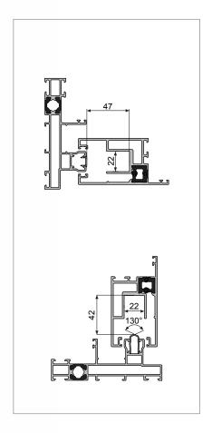
Применяется на профилях с пазом 22х42 и подходит для всех типов. Ролики грузоподъемностью 300 кг и дополнительные комплекты роликов для увеличения грузподъёмности до 400 кг.
